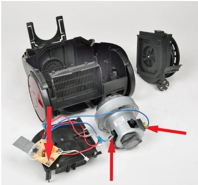
13. Die zwei mit Pfeilen gekennzeichneten Kabelflachsteckhülsen von der Motor-gebläseeinheit lösen und entfernen.
