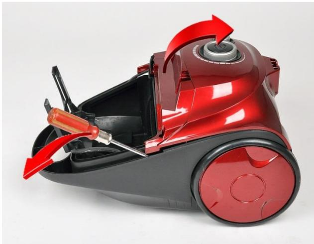
7. Gehen Sie mit einem Schraubendreher zwischen Gehäuseober- und unterteil und nehmen das Gehäuseoberteil ab.
