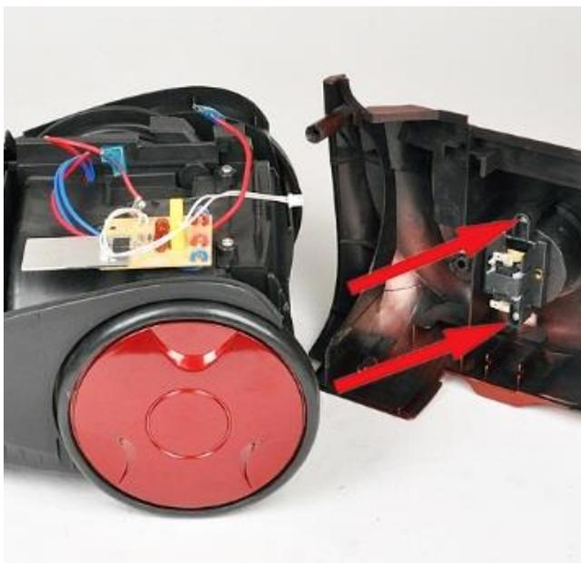
8. Die zwei mit Pfeilen gekennzeichneten Schrauben lösen und den Schalter entfernen.
