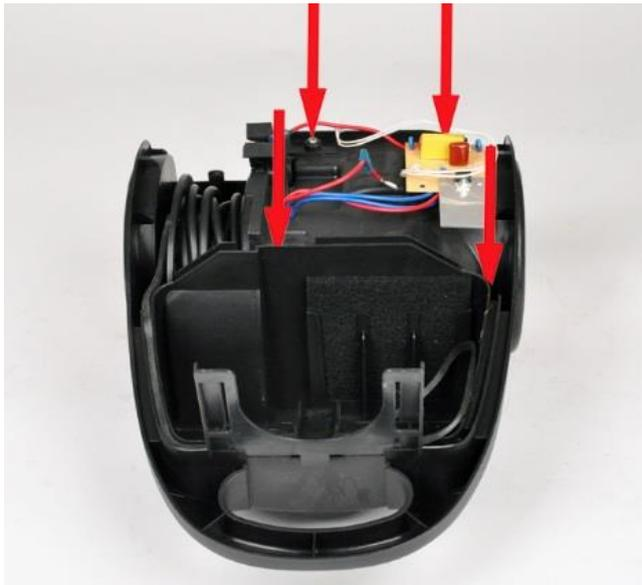
9. Die vier mit Pfeilen gekennzeichneten Schrauben lösen und entfernen.
