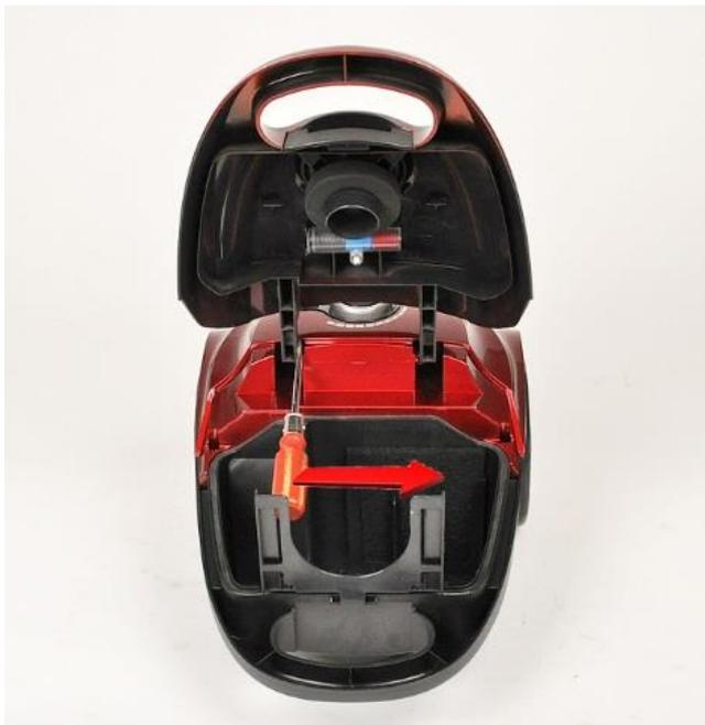
4. Entnehmen Sie den Deckel des Staubbehälters, indem Sie mit einem Schraubendreher den Deckel am Scharnier aushebeln und aus der Führung ziehen.
