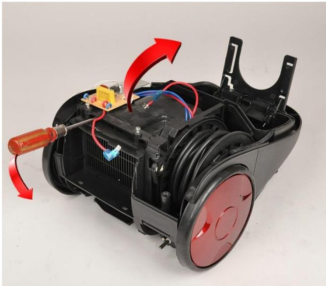
10. Gehen Sie mit einem Schraubendreher zwischen Abdeckung und Gehäuse und nehmen die Abdeckung ab.
