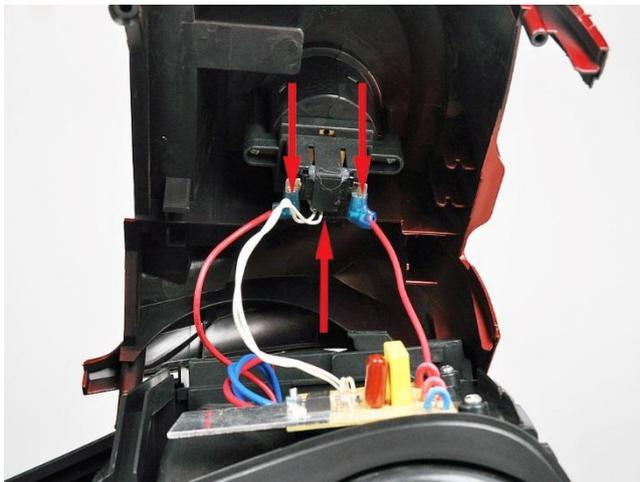
7. Die drei mit Pfeilen gekennzeichneten Kabelflachsteckhülsen und Steckverbinder vom Schalter lösen und entfernen.
