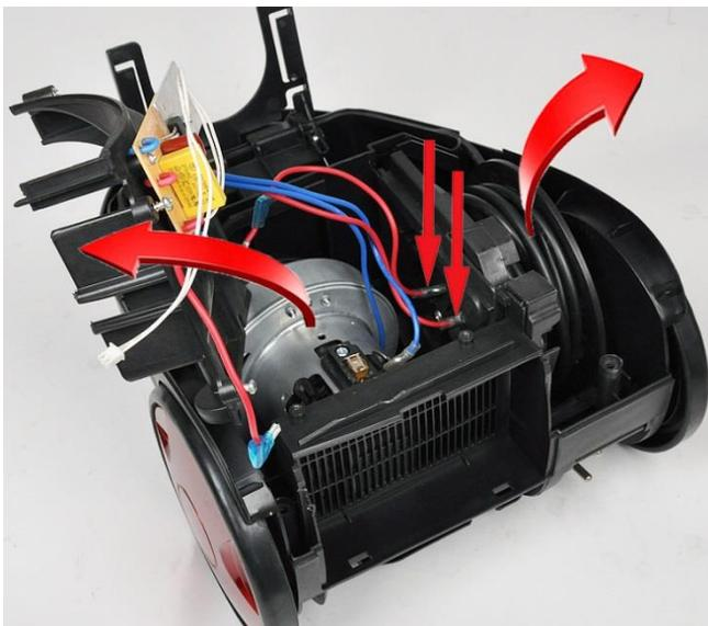
11. Die zwei mit Pfeilen gekennzeichneten Kabelflachsteckhülsen von der Kabelaufwicklung lösen und entfernen.
